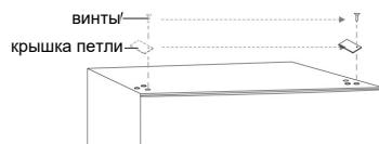
19. Закрепите верхний шарнир в верхней левой части тремя винтами, которые вы удалили ранее. Перед тем, как затягивать винты верхнего шарнира, убедитесь, что верхняя часть двери находится на одном уровне с корпусом, а резиновая прокладка обеспечивает хорошее уплотнение.
