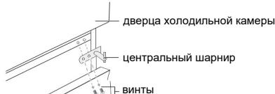
5. Снимите дверцу морозильной камеры.
