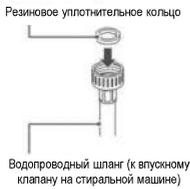
**2** . Рукой плотно навинтите шланги подачи воды на водопроводные краны, а затем затяните еще на 2/3 оборота с помощью плоскогубцев, - синий шланг подключается к крану с холодной водой.
