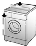
машину на деревянные подкладки или что-то подобное. Убедитесь, что все четыре ножки плотно касаются пола, в этом случае уровень машины полностью горизонтален.
