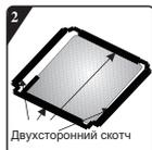
Наклоните машину под углом 40 ° так, чтобы сторона с прямоугольным вырезом была обращена к передней части стиральной машины, как показано на рисунке. Вставьте сторону с косым пазом между двумя ножными винтами сзади стиральной машины на место. Затем установите нижнюю пластину и убедитесь, что она плотно прилегает к дну стиральной машины.
