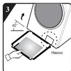
Прижмите двухсторонний скотч с четырех сторон вручную, чтобы надежно прикрепить пластину шумоподавления к корпусу стиральной машины.
