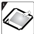
Удалите поверхностную бумагу на двухстороннем скотче с четырех сторон нижней пластины.
